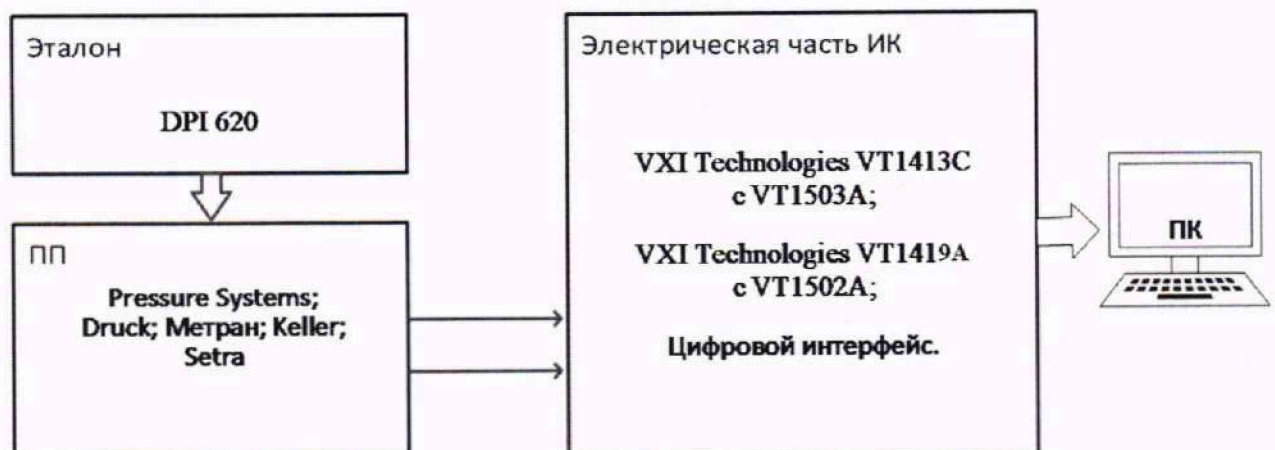
Рисунок 2 – Схема поверки ИК МИД
