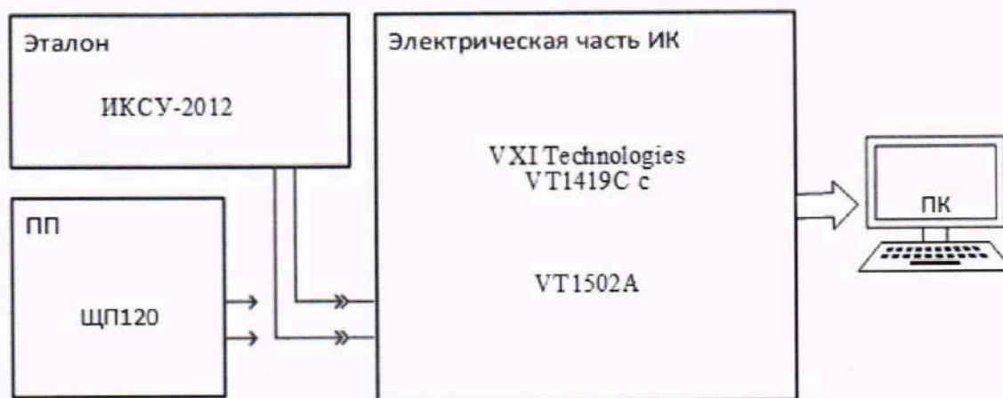
Рисунок 10 – Схема поверки ИК МИНЧС
