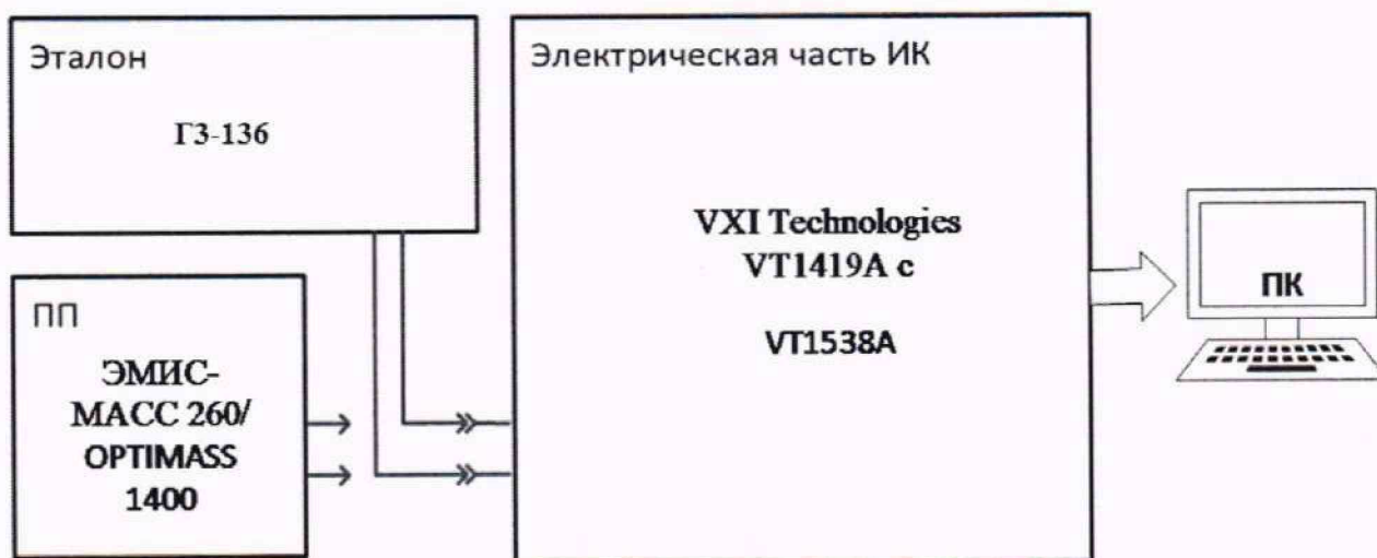
Рисунок 1 – Схема поверки ИК МИРТ
