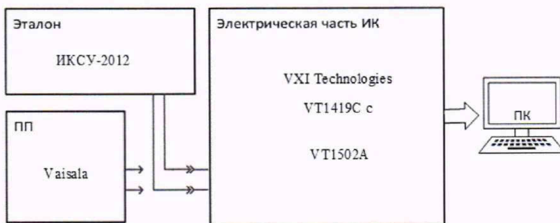
Рисунок 9 – Схема поверки ИК МИВ
