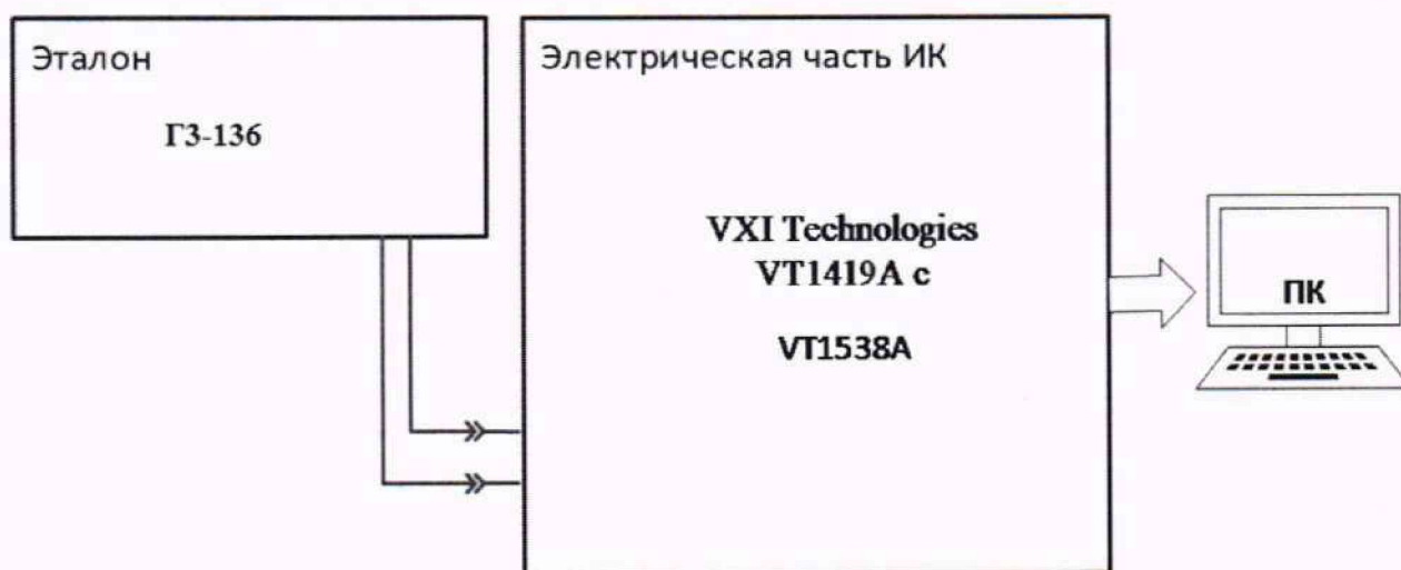
Рисунок 8 – Схема поверки ИК МИЧВР
