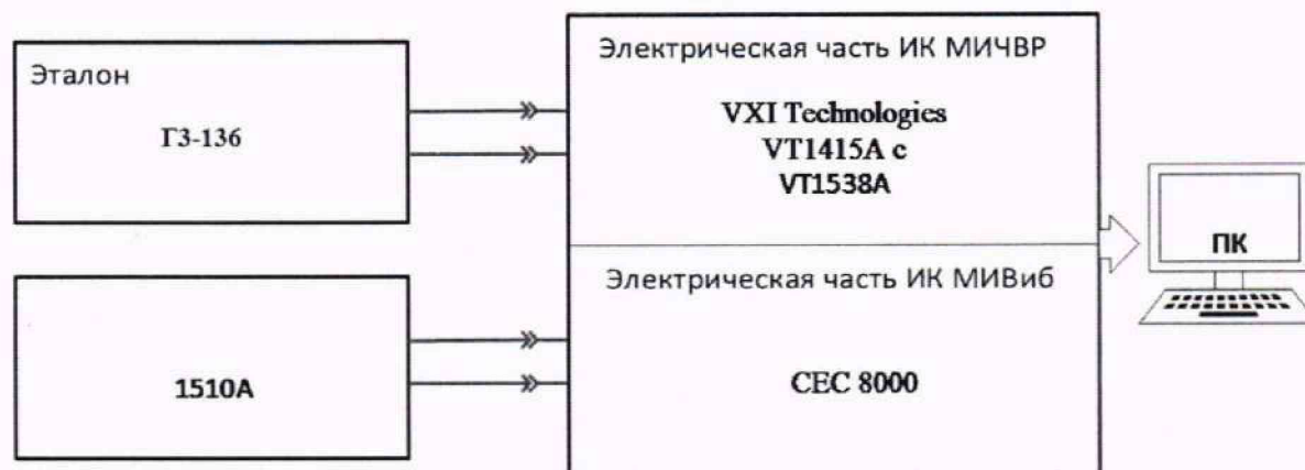
Рисунок 6 – Схема поверки ИК МИВиБ
