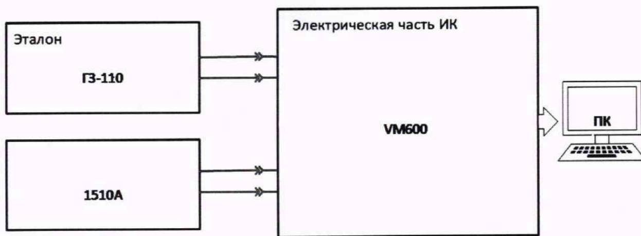
Рисунок 6 – Схема поверки ИК МИВиб
