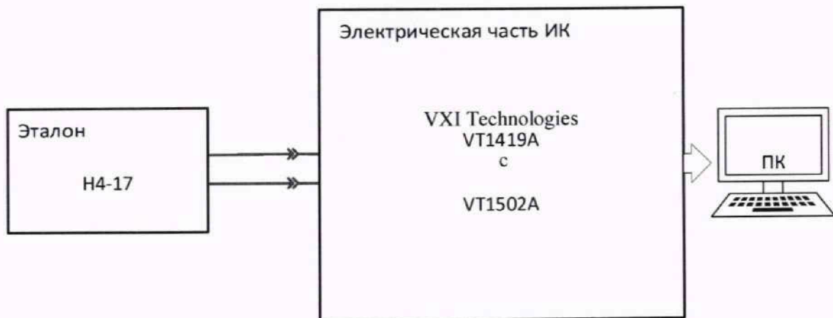
Рисунок 11 – Схема поверки ИК напряжения постоянного тока МИАВ
