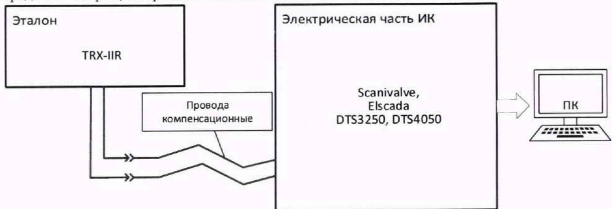
Рисунок 4 – Схема поверки ИК напряжения постоянного тока, соответствующего температуре газа по тракту двигателя
