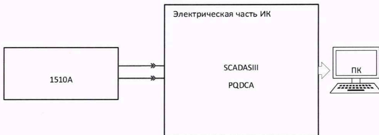
Рисунок 8 – Схема поверки ИК МИВиБ (ИК виброускорений и пульсаций давления)
