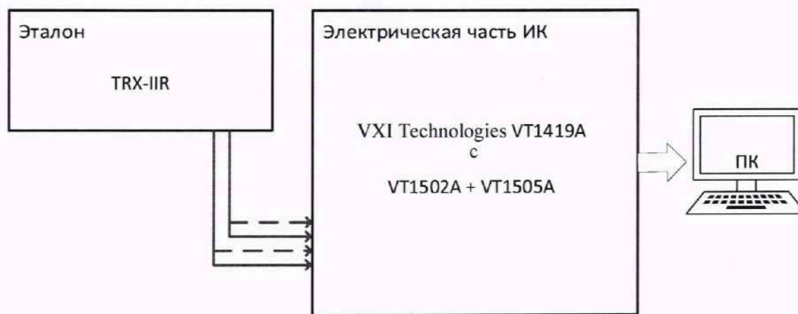
Рисунок 5 – Схема поверки ИК сопротивления постоянному току, соответствующего температуре газа (жидкости) по тракту двигателя
