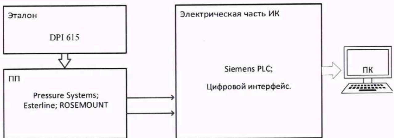
Рисунок 2 – Схема поверки ИК МИД
