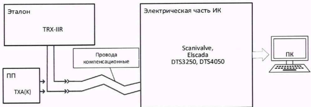
Рисунок 3 – Схема поверки ИК МИТ с ПП термоэлектрического типа
