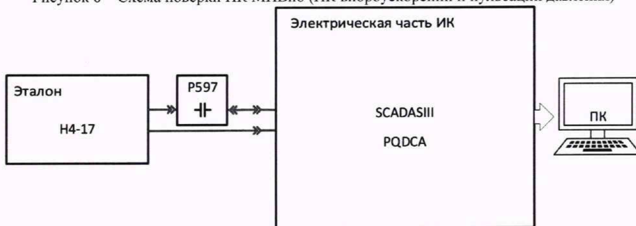
Рисунок 9 – Схема поверки ИК МИВиБ (ИК виброускорений и пульсаций давления) при использовании меры емкости и калибратора напряжения переменного тока
