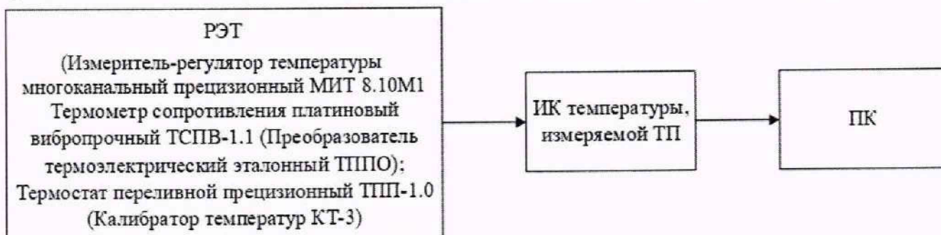
Рисунок 5 - Схема поверки ИК температуры, измеряемой КТХА (К), РЭТ МИТ 8.10М1 с ТСПВ-1.1 (ТППО) и ТПП-1.0 (КТ-3)
