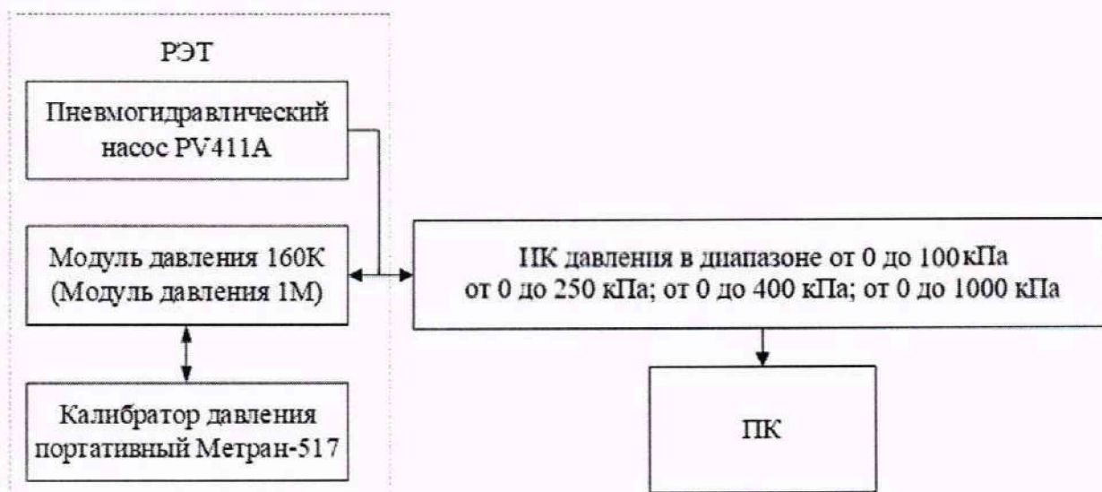
Рисунок 2 - Схема поверки ИК давления (РЭТ Метран-517/Датчик (Датчик)/PV411А)
