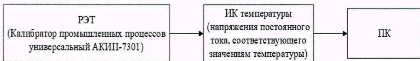
Рисунок 6 - Схема поверки ИК температуры (напряжения постоянного тока, соответствующего значениям температуры), РЭТ калибратор промышленных процессов универсальный АКПП-7301
