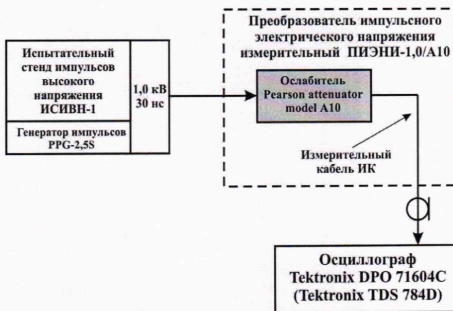
Рисунок 3 – Схема соединений при определении максимального измеряемого значения амплитуды импульсов электрического напряжения
