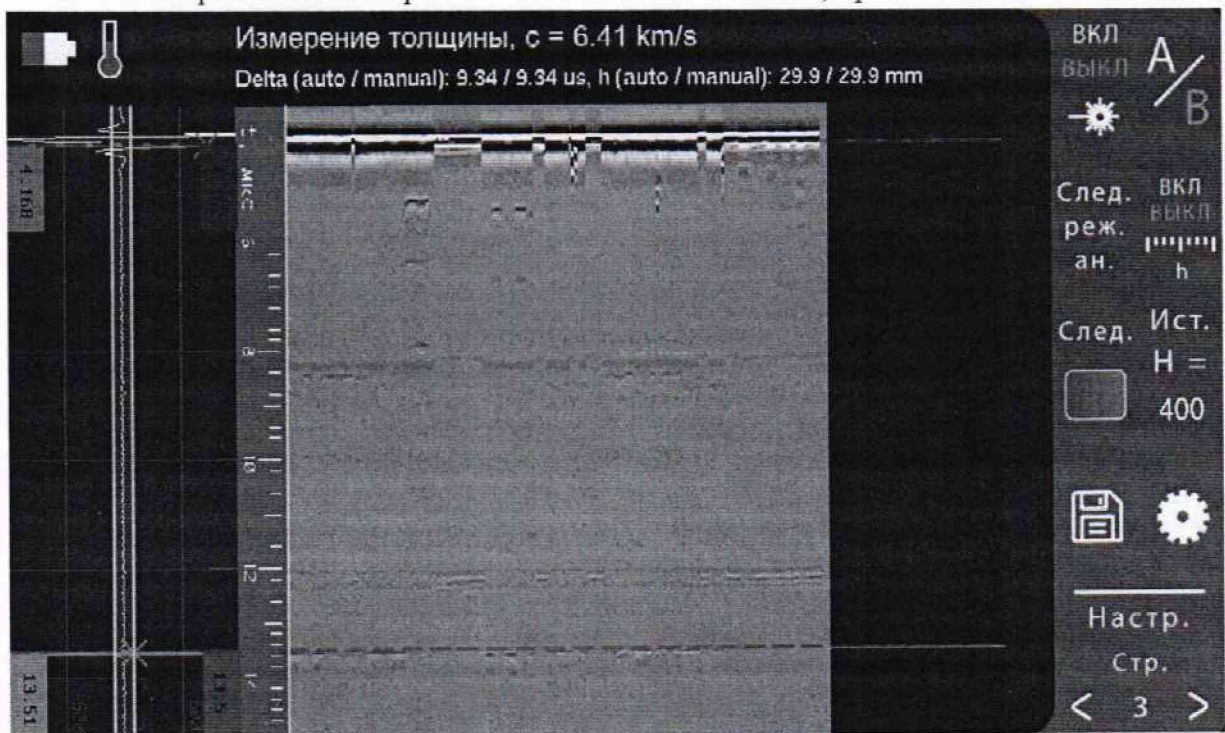
Рисунок 2 – Отображение донного сигнала на А и В-скане
