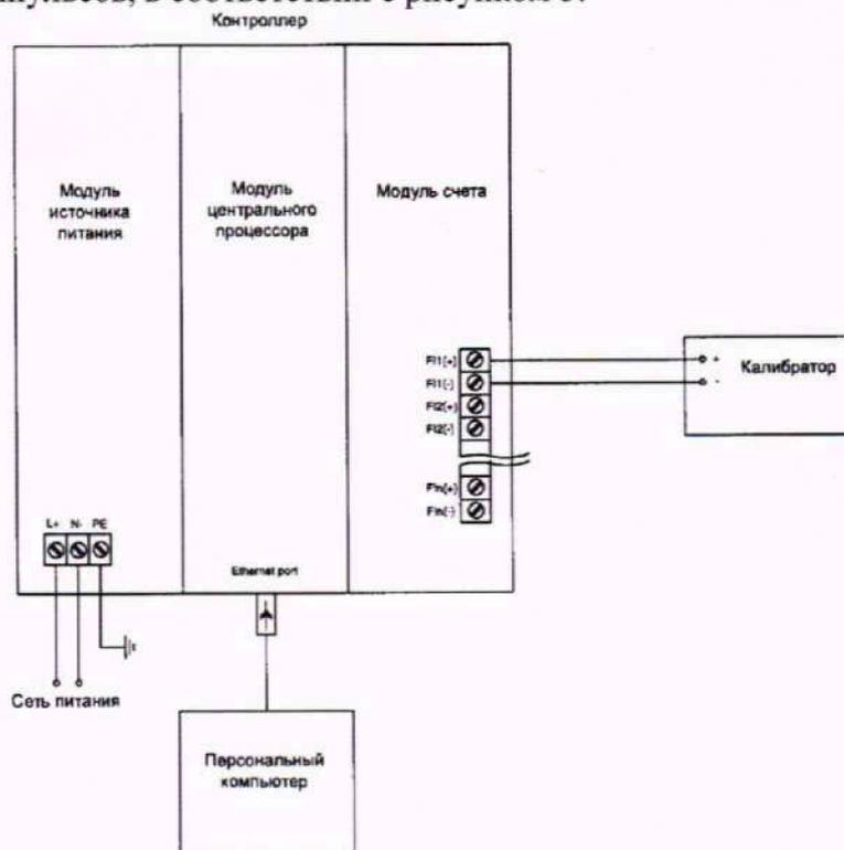
Рисунок 5 – Схема определения погрешности измерений импульсных сигналов
