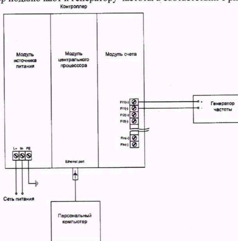
Рисунок 4 – Схема определения погрешности измерений частотных сигналов
