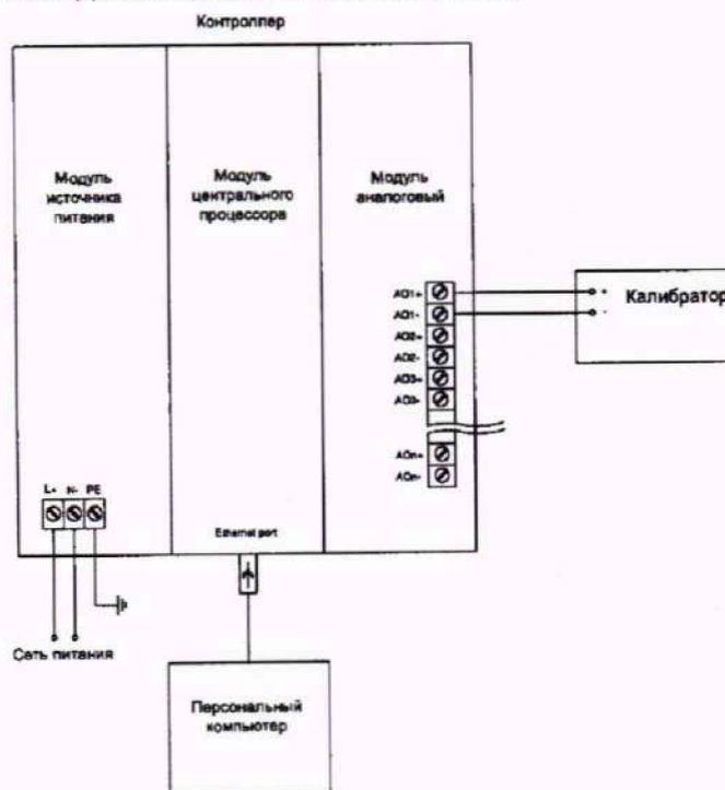
Рисунок 2 – Схема определения основной погрешности воспроизведения аналоговых сигналов
