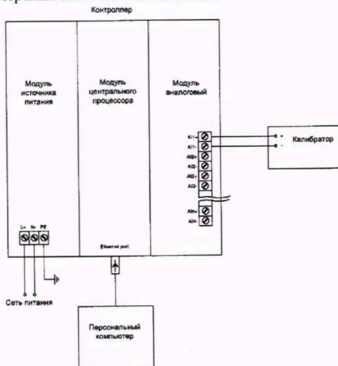
Рисунок 1 – Схема определения основной погрешности измерений аналоговых сигналов
