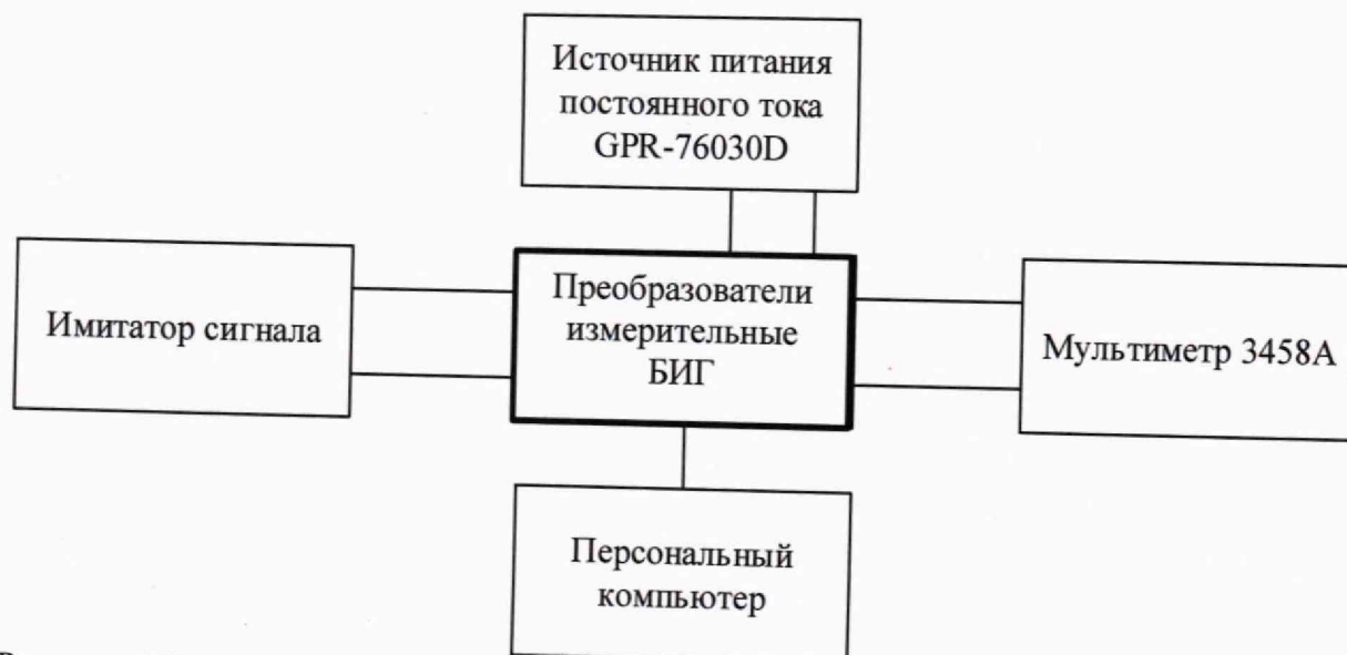
Рисунок А.1 – Схема определения основной приведенной (к верхнему пределу диапазона входного сигнала) погрешности преобразователя Имитатор сигналов - Калибратор многофункциональный и коммуникатор ВЕАМЕХ МС6 (-R), Мера электрического сопротивления постоянного тока многозначная МС3070М-1, Генератор сигналов специальной формы АКПП-3409/1
