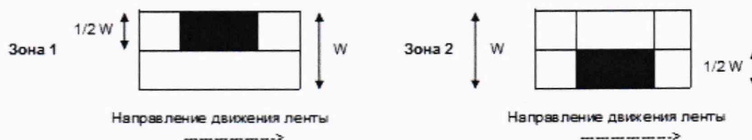
Рисунок 1 — Расположение испытательных нагрузок для СИ
