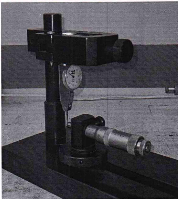
**Рисунок А.1 – Приспособление для определения погрешности индикаторов модификаций ИРБ и ИРТ с ценой деления 0,01 мм**
