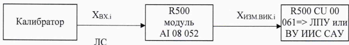
Рисунок 1 – Структурная схема ВИК без ИП в составе с подключенным калибратором
