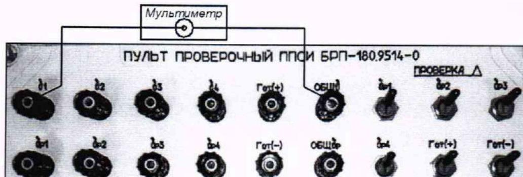
Рисунок 44 – Схема проверки при воспроизведении системой напряжения постоянного тока
