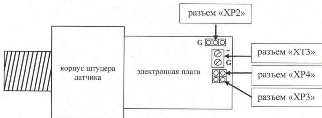
Рисунок 2 – Схема расположения разъемов (датчик с батарейным питанием)
