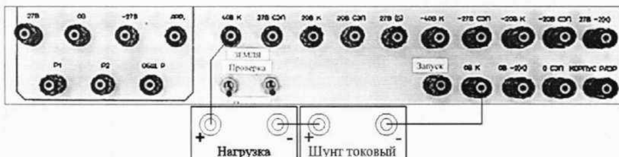
Рисунок 99 - Схема измерения силы постоянного тока по цепи «40 В (к)»
