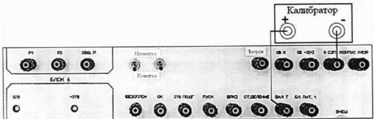
Рисунок 83 - Схема подключения мультиметра по цепи «Вкл.Т»
