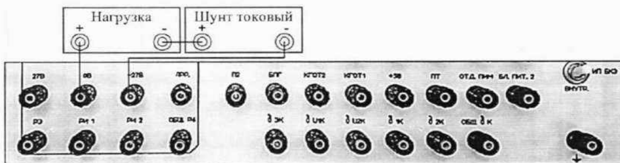
Рисунок 104 - Схема измерения силы постоянного тока по цепи «-27 В-Бл.6»
