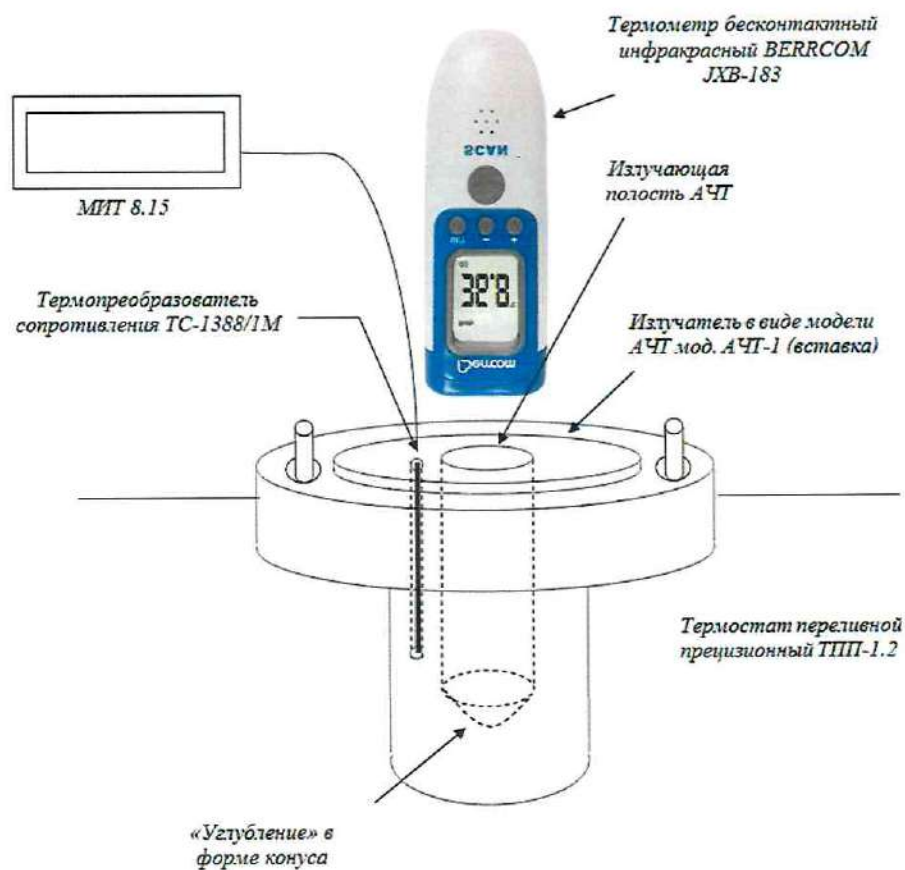
Рисунок 4 – Схема размещения инфракрасного термометра в термостате
