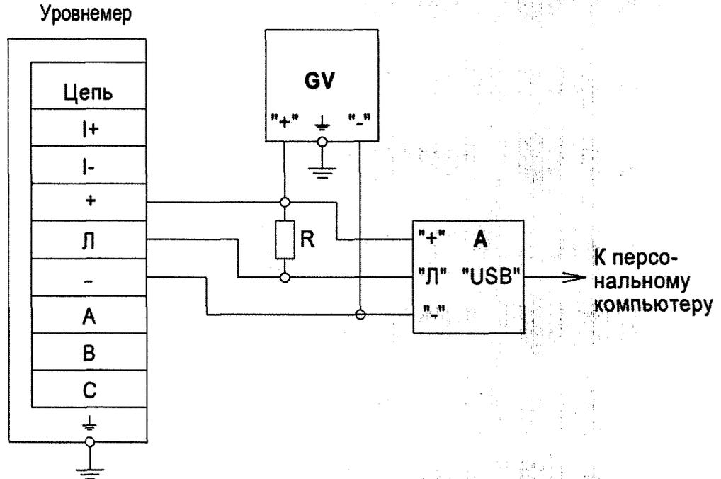
GV – источник питания постоянного тока с установленным выходным напряжением  $(12 \pm 1)$  В;
