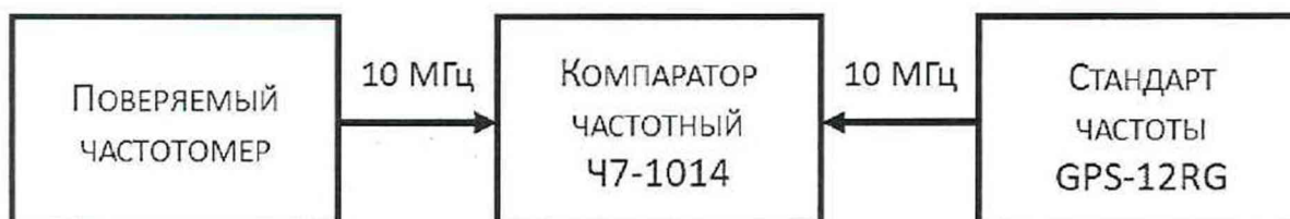
Рисунок 1 – Схема определения нестабильности и относительной погрешности по частоте ОГ частотомера
