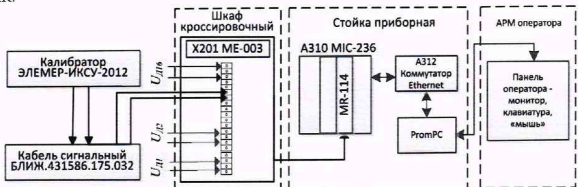
Рисунок 17 – Схема поверки ИК напряжения постоянного тока
