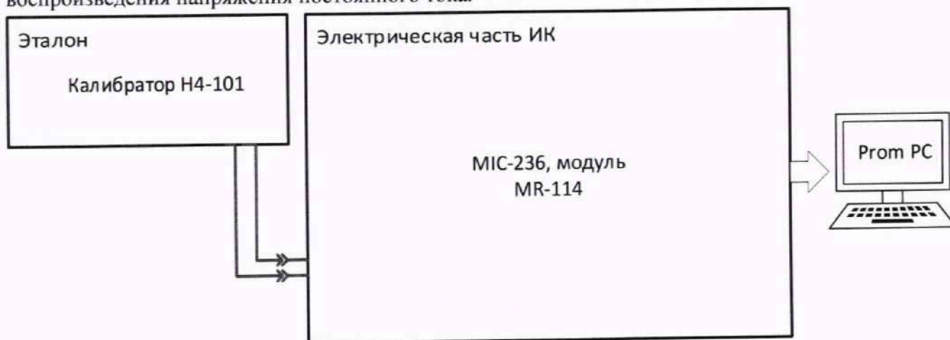
Рисунок 21 – Схема поверки ИК напряжения постоянного тока
