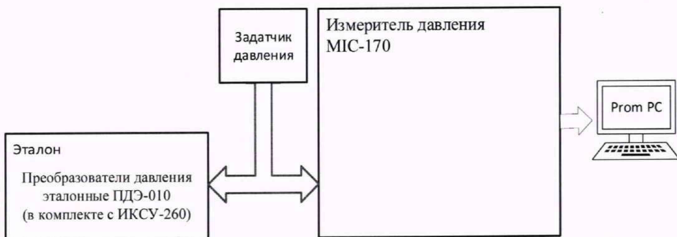
Рисунок 19 – Схема поверки ИК давления газов и жидкостей комплектным способом
