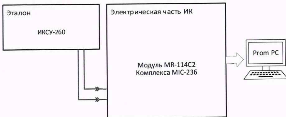
Рисунок 22 – Схема поверки ИК силы постоянного тока
