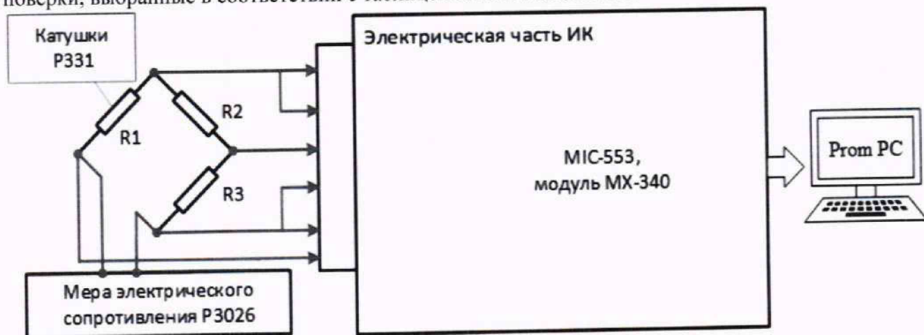
Рисунок 23 – Схема поверки ИК относительного напряжения тензодатчиков
