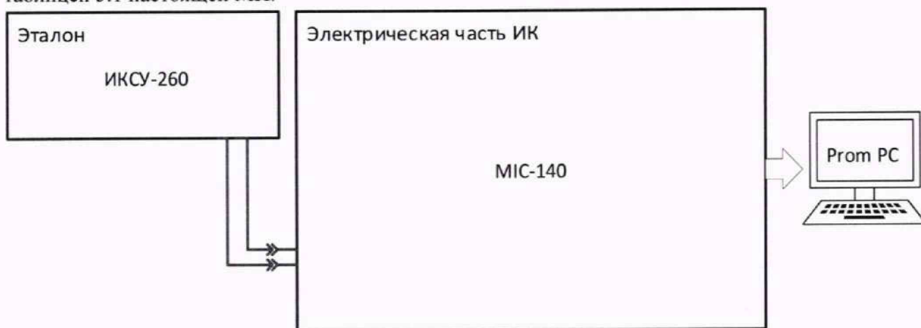
Рисунок 17 – Схема поверки напряжения постоянного тока, соответствующего температуре
