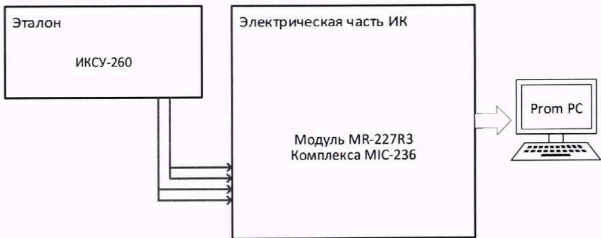
Рисунок 18 – Схема поверки ИК сопротивления постоянному току, соответствующего температуре
