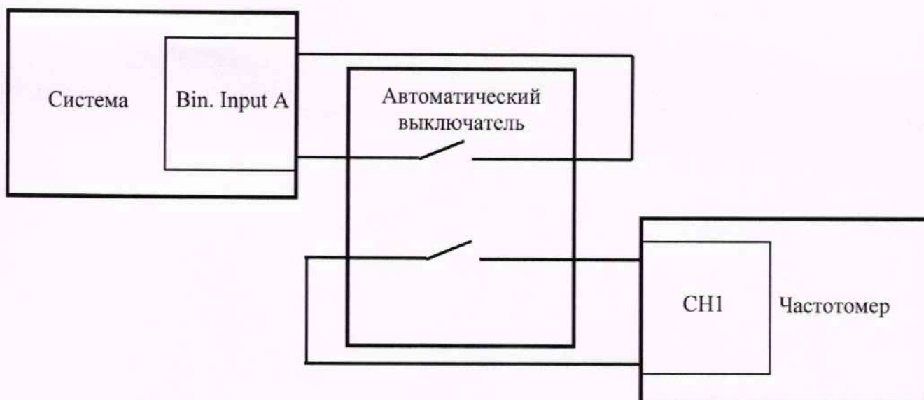
Рисунок 7 – Структурная схема определения погрешности измерений интервалов времени
