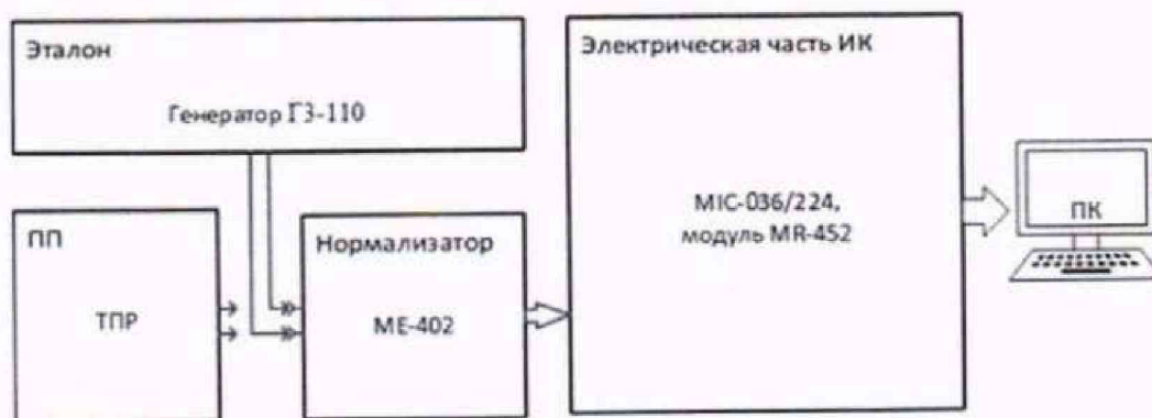
Рисунок 18 – Схема поверки ИК объемного расхода
