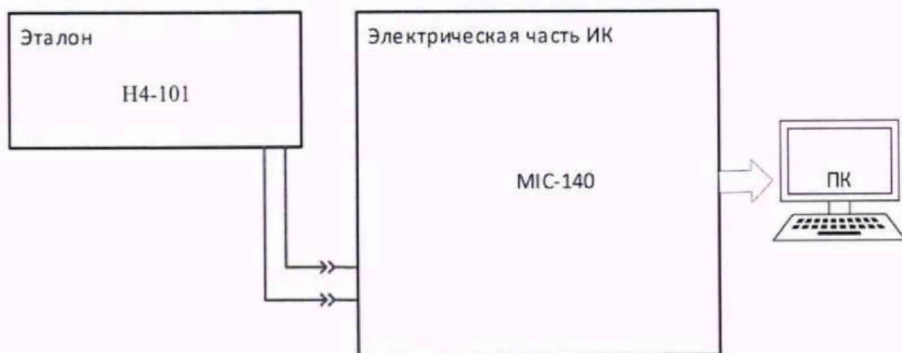
Рисунок 21 – Схема поверки ИК напряжения постоянного тока, соответствующего значениям температуры газообразных сред в диапазоне преобразований первичных измерительных преобразователей термоэлектрического типа ХА (К)
