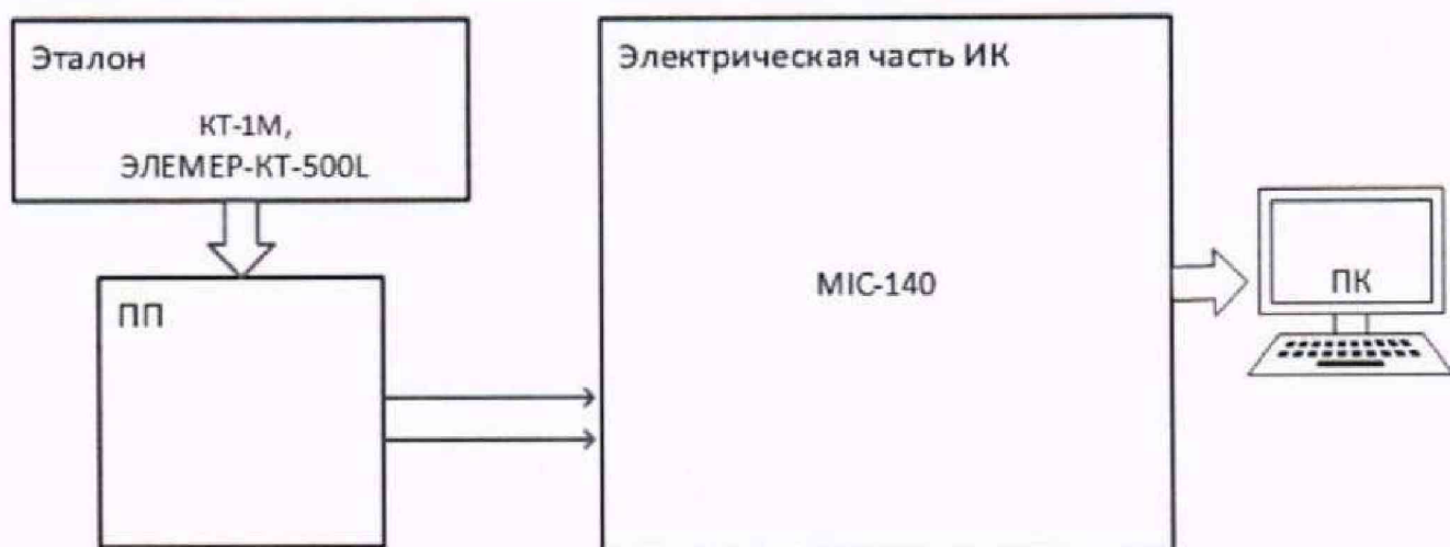
Рисунок 23 – Схема поверки ИК температуры, измеренной ПП термоэлектрического типа ХК (L)
