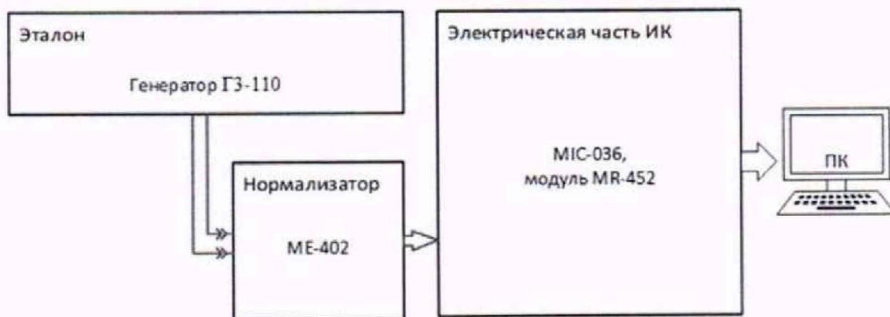
Рисунок 31 – Схема поверки ИК частоты переменного трехфазного тока
