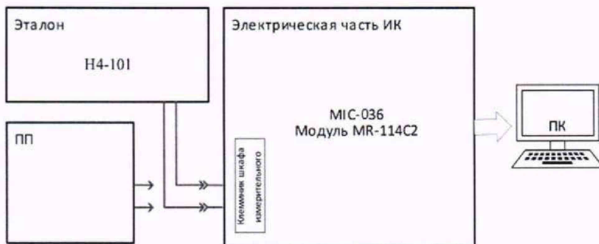
Рисунок 26 – Схема поверки ИК напряжения постоянного тока, соответствующего значениям виброскорости
