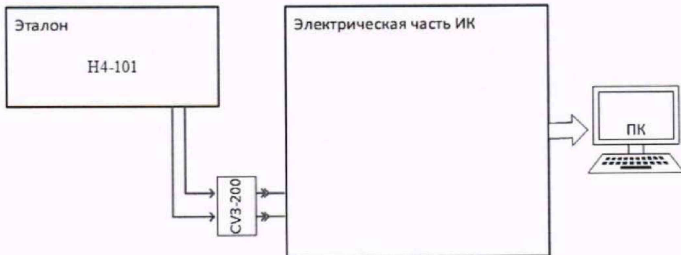
Рисунок 30 – Схема поверки электрической части ИК напряжения переменного тока
