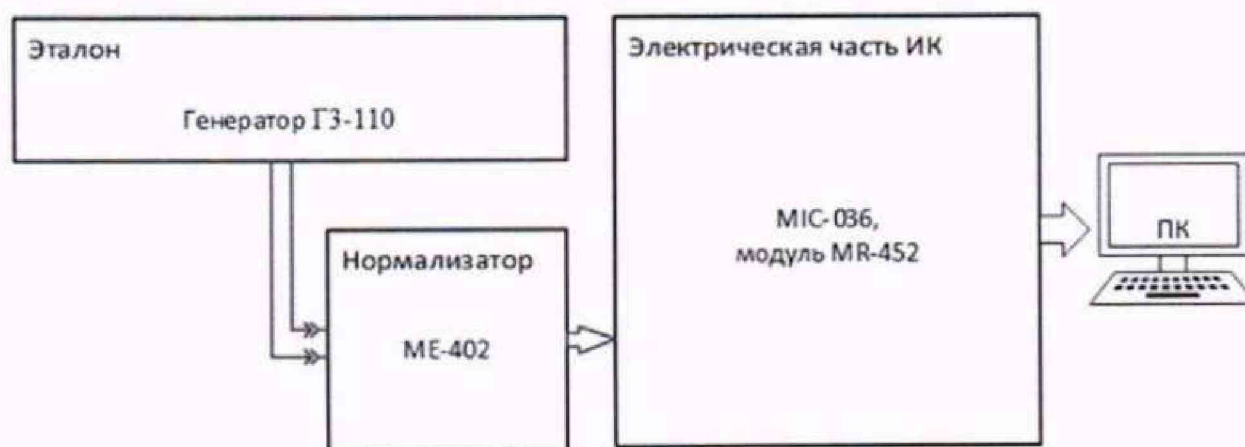
Рисунок 17 – Схема поверки ИК частоты переменного тока, соответствующего частоте вращения ротора
