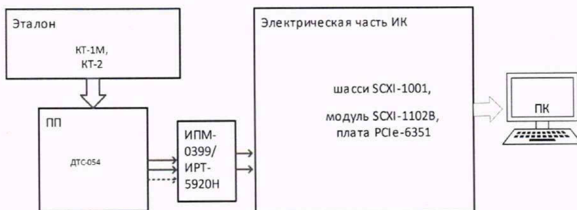
Рисунок 4 – Схема проверки ИК температур газобразных и жидких сред комплектным способом
