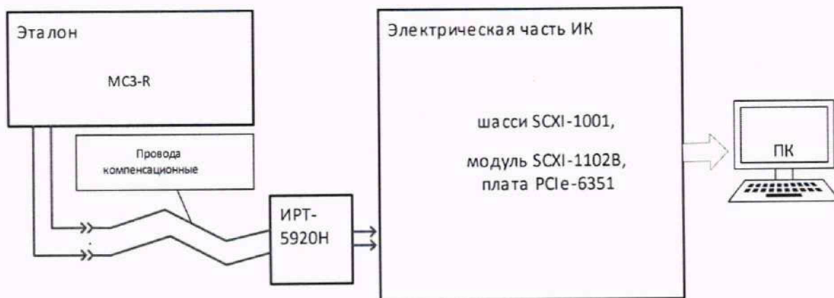
Рисунок 5 – Схема поверки ИК сигналов от датчиков температуры (ТЭДС термопар, соответствующих температуре)
