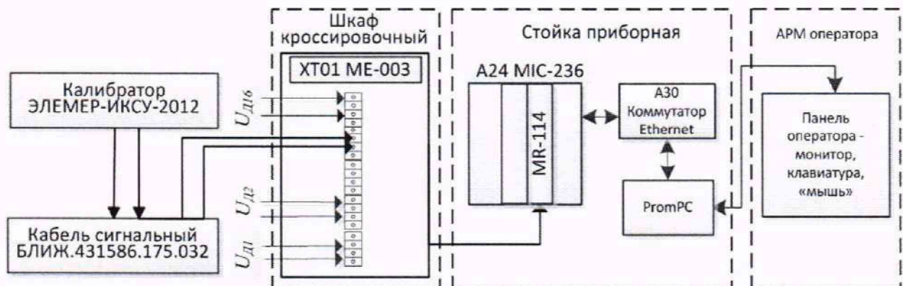
Рисунок 17 – Схема поверки ИК напряжения постоянного тока
