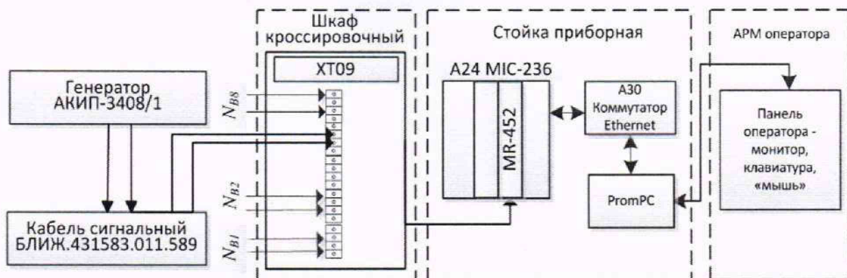
Рисунок 19 – Схема поверки электрической части ИК частоты периодического сигнала
