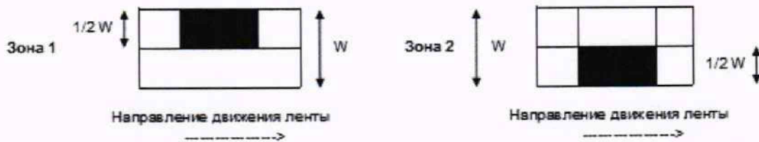
Рисунок 1 — Расположение испытательных нагрузок для СИ, осуществляющих взвешивание динамически
