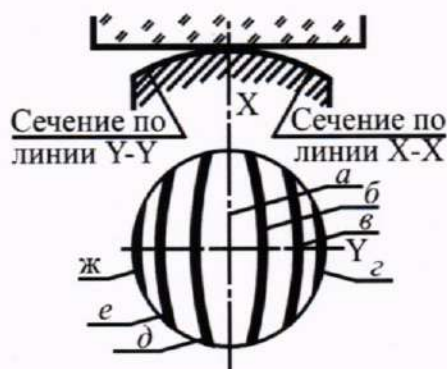
Рисунок 3 – Изображение картины интерференционных полос (колец) для цилиндрической формы измерительной поверхности
