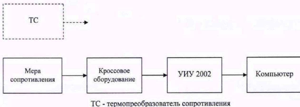
Рисунок 5 - Схема определения метрологических характеристик ИК сопротивления постоянному току, соответствующего значениям температуры, измеряемой термопреобразователями сопротивления по ГОСТ 6651-2009
