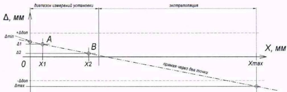
Рис.3 – График зависимости погрешности измерений  $\Delta$  от уровня измеренного  $X$  для уровнемера, с построением участка экстраполяции
