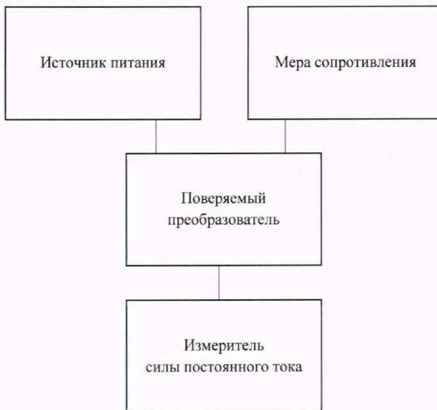
Рисунок 4 – Схема подключений для определения основной погрешности преобразований сигналов электрического сопротивления постоянному току и сигналов потенциометров.
