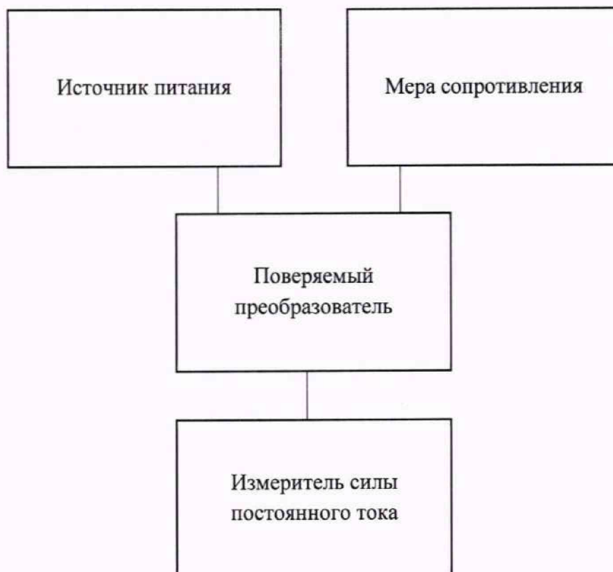
Рисунок 2 – Схема подключений для определения основной погрешности преобразований сигналов термопреобразователей сопротивления.
