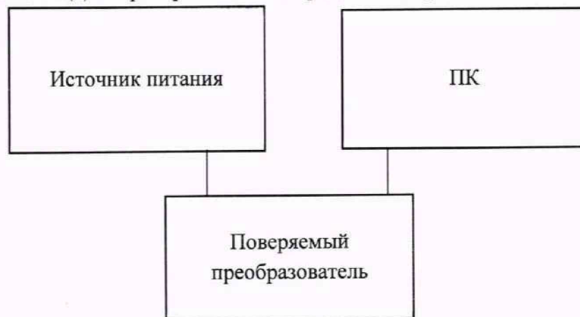
Рисунок 1 – Схема подключений для подачи напряжения питания на преобразователь и подключение к ПК
