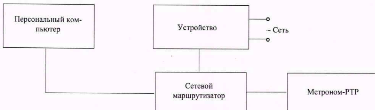
Рисунок 3 - Схема подключений при определении абсолютной погрешности хода часов за сутки
