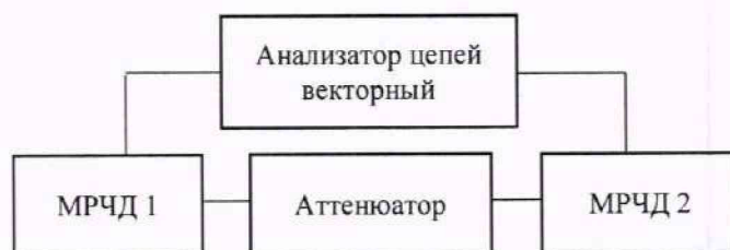
Рисунок 4 – Схема измерения модуля коэффициента передачи |S_{ji}|
