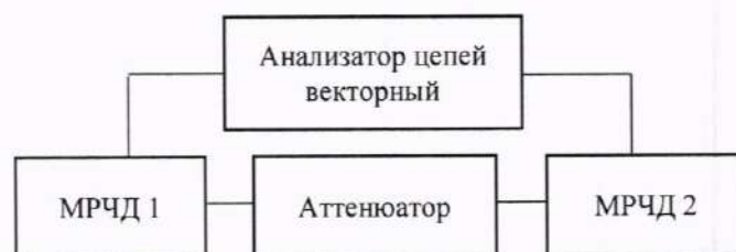
Рисунок 4 – Схема измерения модуля коэффициента передачи |S_{ji}|
