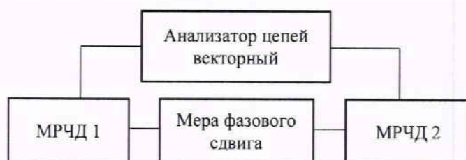
Рисунок 5 – Схема измерения фазы коэффициента передачи |S_{ji}|
