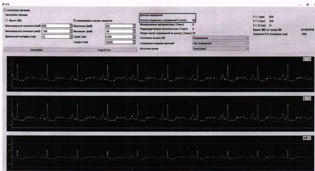
Рисунок 9 - Вид сервисной программы в режиме измерения ЧСС
