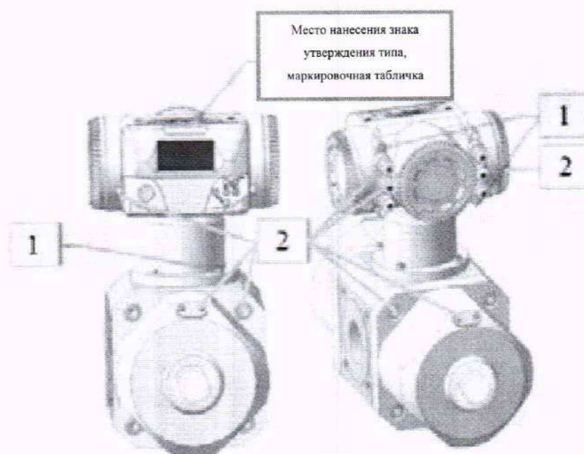
Рисунок Б.5 – Места пломбировки комплекса варианта исполнения V, VP с вертикальным расположением патрубков, указание места нанесения знака утверждения типа, расположение маркировочной таблички
