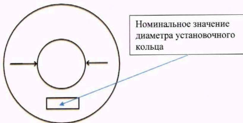
Рисунок 2 – Направление измерений диаметра установочного кольца
