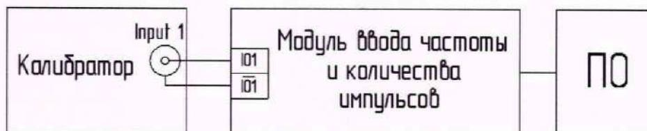
Рисунок 7 – Схема подключения для определения погрешностей
