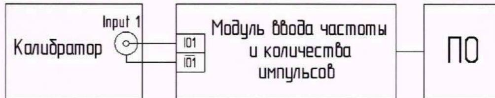
Рисунок 6 – Схема подключения для определения погрешностей
