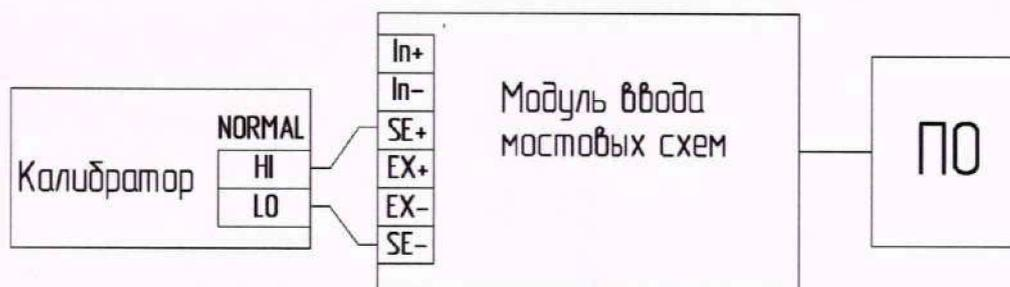
Рисунок 9 – Схема подключения для определения погрешностей
