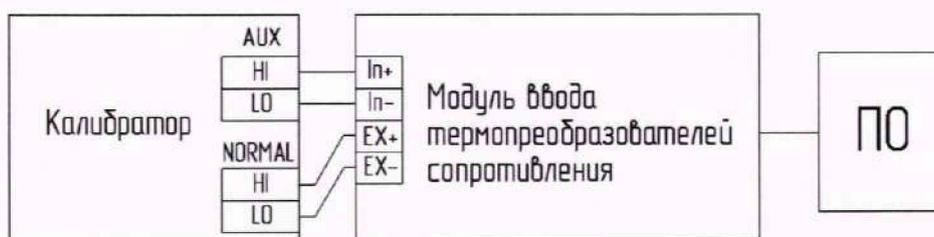
Рисунок 3 – Схема подключения для определения погрешностей
