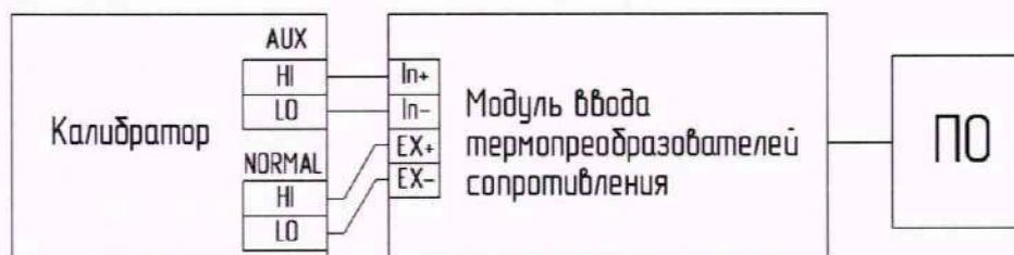
Рисунок 4 – Схема подключения для определения погрешностей
