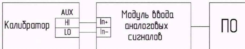
Рисунок 2 – Схема подключения для определения погрешностей
