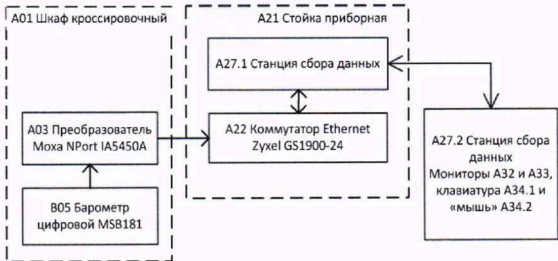
Рисунок 20 – Схема ИК давления атмосферного воздуха
