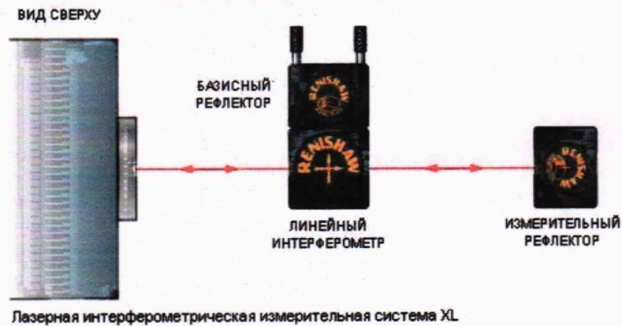
Рисунок 1 – Схема измерения параметра по оси X
