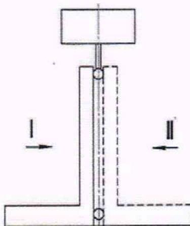
Рисунок 5 – Определение отклонения от перпендикулярности измерительной поверхности Б к опорной поверхности Г угольника на ППУ-630
