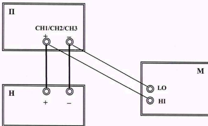
Рисунок 1 – Схема подключения оборудования при определении абсолютной погрешности воспроизведения напряжения постоянного тока, где П – поверяемый прибор;
