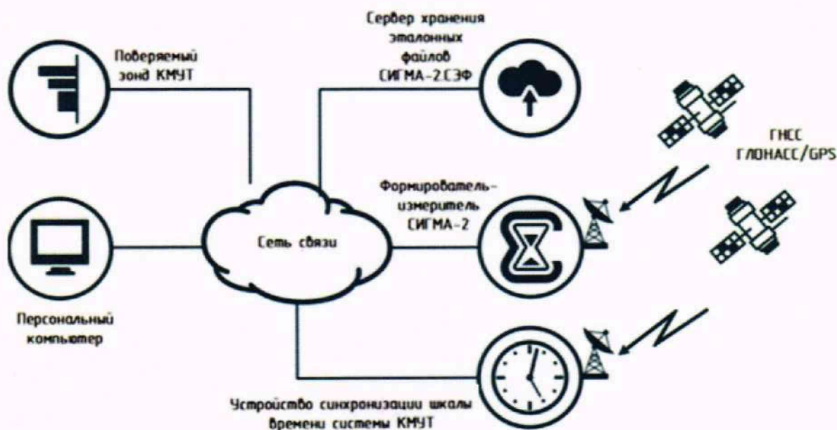
Рисунок 7 – Схема измерений при поверке зонда КМУТ
