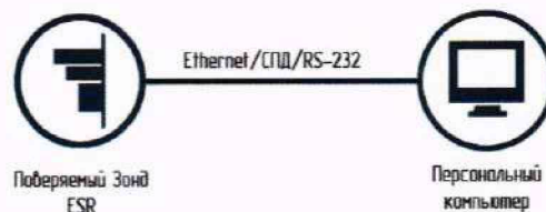
Рисунок 1 – Схема измерений для настройки сетевого интерфейса зонда КМУТ
