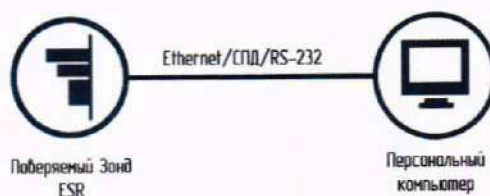
Рисунок 1 – Схема измерений для настройки сетевого интерфейса зонда КМУТ
