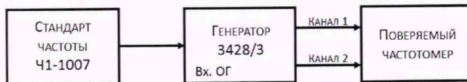
Рисунок 4 – Схема определения погрешности измерений временных интервалов
