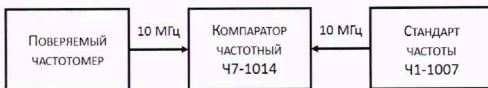
Рисунок 1 – Схема определения нестабильности и относительной погрешности по частоте опорного генератора частотомера
