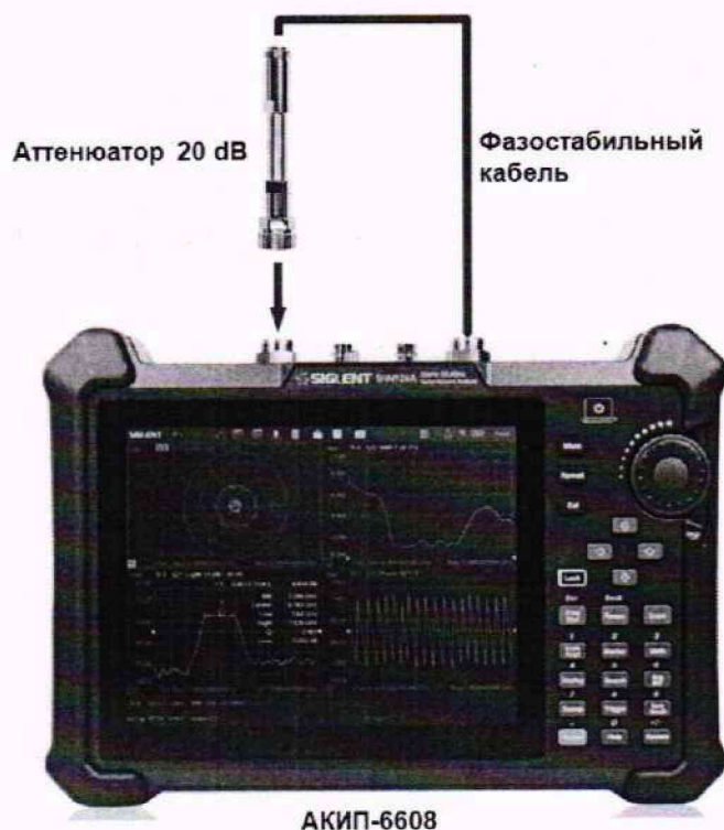
Рисунок 6 – Схема соединения приборов для определения погрешности измерения модуля и фазы коэффициента передачи
