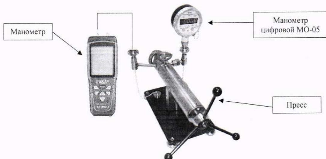
Рисунок 1 – Схема подключений при определении абсолютной и приведенной (к верхнему пределу диапазона измерений) погрешностей измерений давления разрежения, дифференциального и избыточного давления
