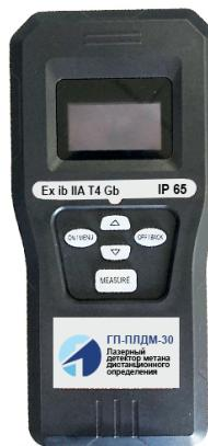
Портативный лазерный детектор предназначен для определения содержания метана на расстоянии до 30 метров.
