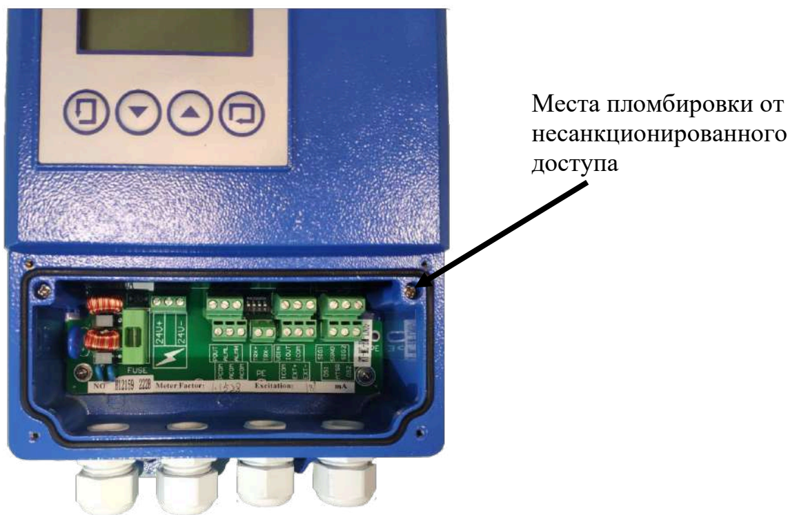
Рисунок 9. Схема пломбировки вторичного преобразователя
