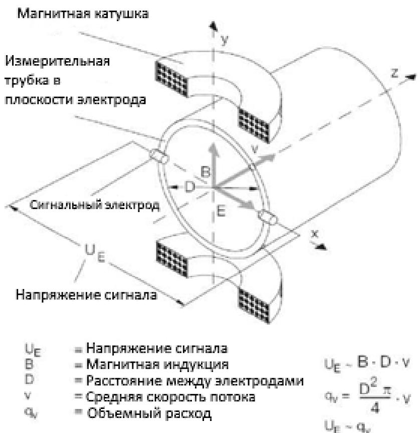
Схема электромагнитного расходомера
