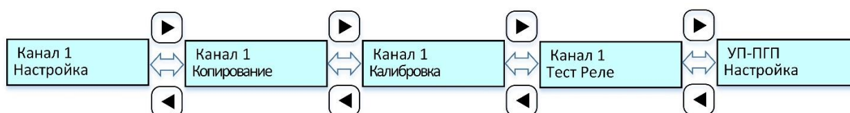
Рисунок 7 – Циклограмма выводимых сообщений на дисплей при настройке УП с канальными платами при включенном канале
