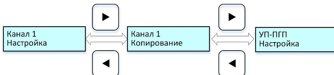
Рисунок 6 – Циклограмма выводимых сообщений на дисплей при настройке УП с канальными платами при выключенном канале
