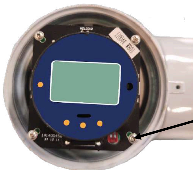
Рисунок 12. Схема пломбировки ВП МТ150НС
