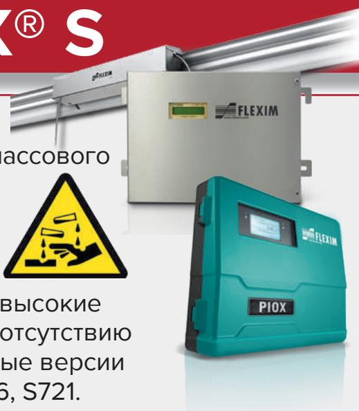
Два накладных ультразвуковых датчика устанавливаются на стенках трубы и поочередно посылают и принимают ультразвуковые сигналы. Измеряя разность времени прохождения сигнала по течению потока и против, PIOX® S при заданных параметрах трубы точно рассчитывают скорость ультразвука в среде, скорость потока ( $v$ ) и объемный расход. Датчик температуры, устанавливаемый накладным или врезным
