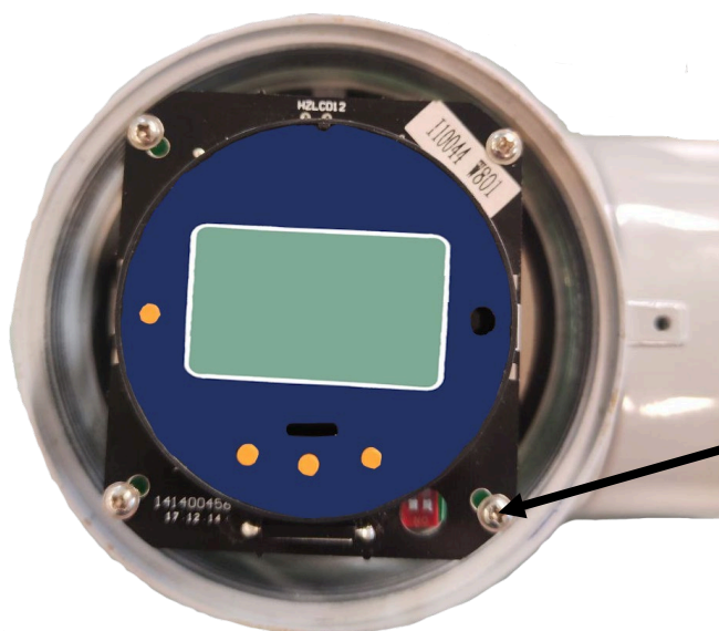
Рисунок 12. Схема пломбировки ВП МТ150НС
