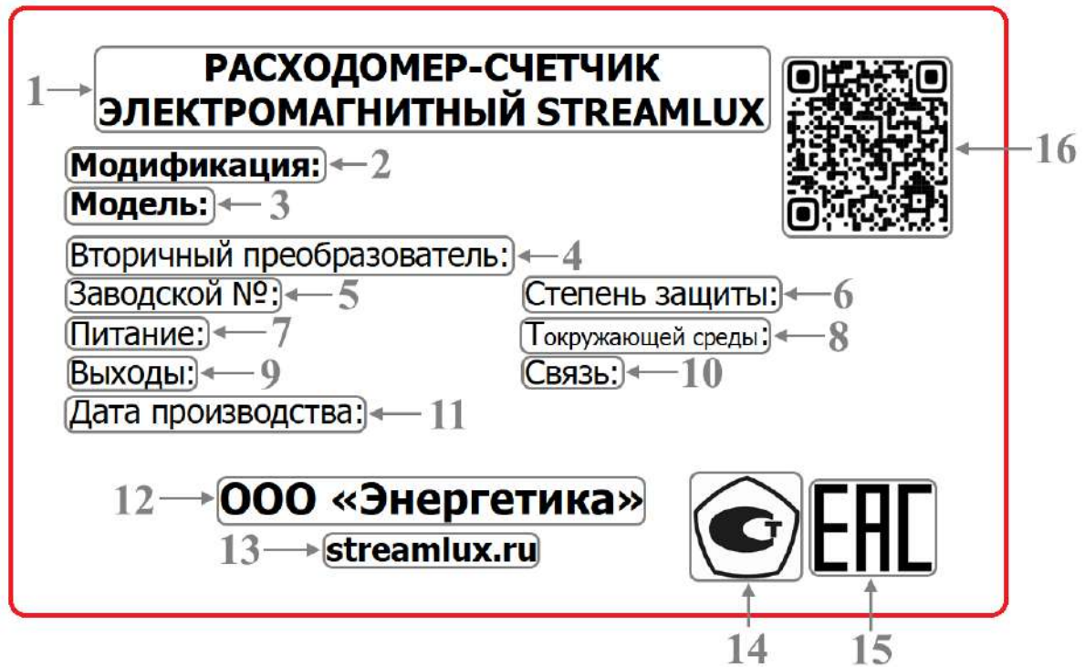
Рисунок 16. Маркировочная табличка вторичного преобразователя
